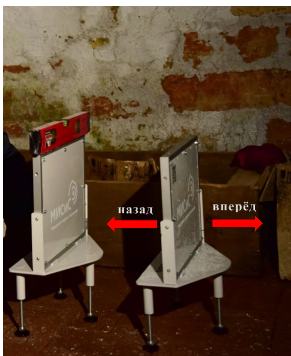
Рисунок 4.4 – Детекторы первой экспозиции, установленные в подвале ЦПБМ.
