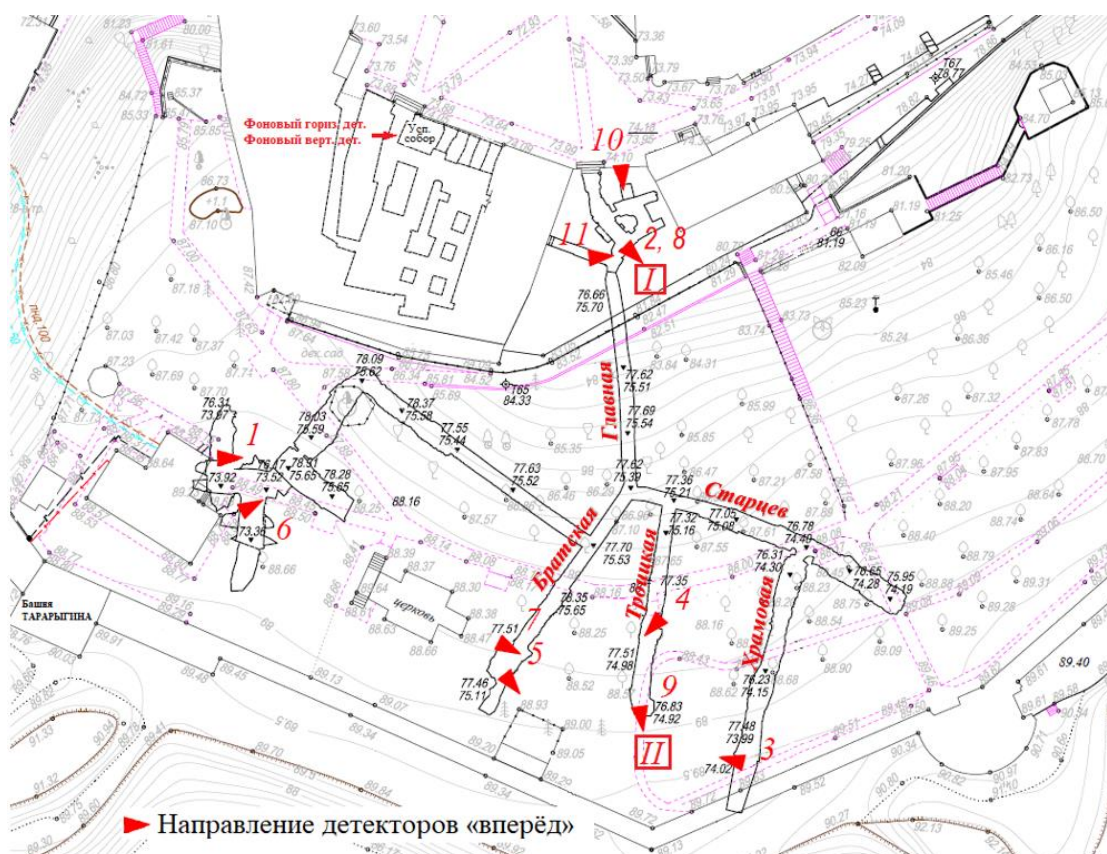
Рисунок 14. Схема расположения детекторов в пещерах Свято-Успенского Псково-Печерского монастыря. Треугольниками обозначено положение детекторов. Острые концы треугольников указывают направление обзора для исследования объектов. Два квадрата на рисунке, обозначенные цифрами I и II, показывают области исследуемых объектов.
