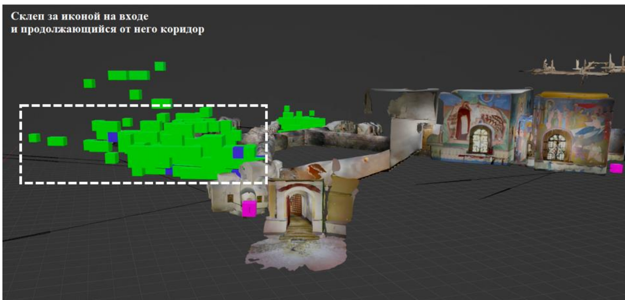
Рисунок 16. Лидарная съемка видимых границ «улиц» Богом зданных пещер с совмещенными экспериментальными результатами. Неизвестные ранее невидимые объекты обозначены зелеными квадратами размером 1 \text{ м}^3 каждый. Белыми пунктирными линиями обозначены границы полостей 1-2.
