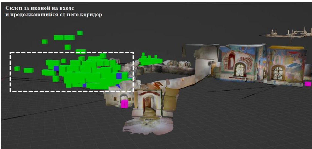
Рисунок 4.75 Лидарная съемка видимых границ «улиц» «Богом зданных пещер» с совмещенными экспериментальными результатами. Неизвестные ранее невидимые объекты обозначены зелеными квадратами размером 1 \text{ м}^3 каждый. Белыми пунктирными линиями обозначены границы полостей 1-2 на рисунке 4.74.
