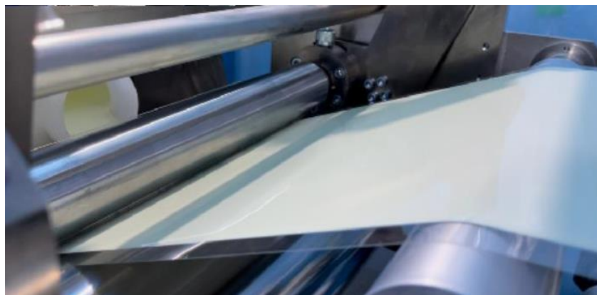
Рисунок 1.12 Пример полива автоматической поливной машиной эмульсионного геля на одну из сторон ТАЦ подложки в университете Нагойи.
