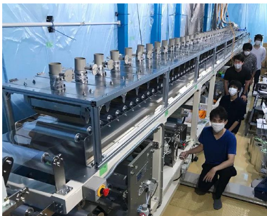
Рисунок 1.11 Внешний вид автоматической поливной машины эмульсионного геля на ТАЦ подложку в университете Нагойи.
