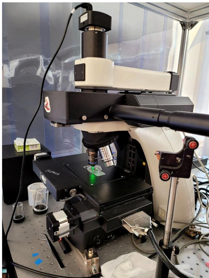
Рисунок 2.6 – Сканирующий конфокальный фотолюминесцентный микроскоп-спектрометр Confotec MR350
