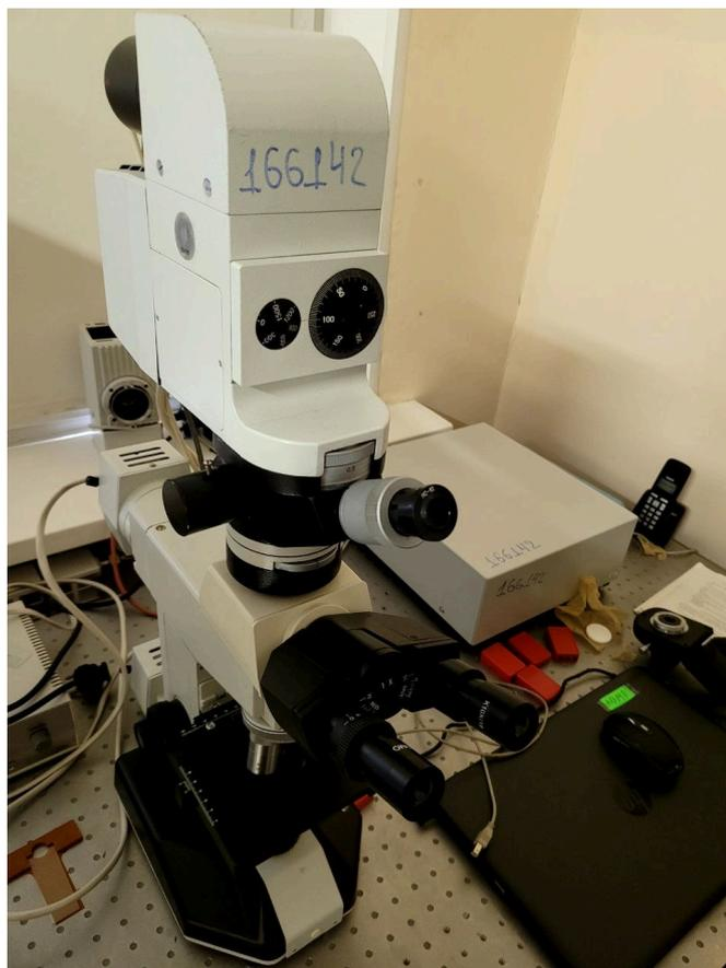
Рисунок 2.4 – Микроскоп-спектрофотометр МСФУ-К
