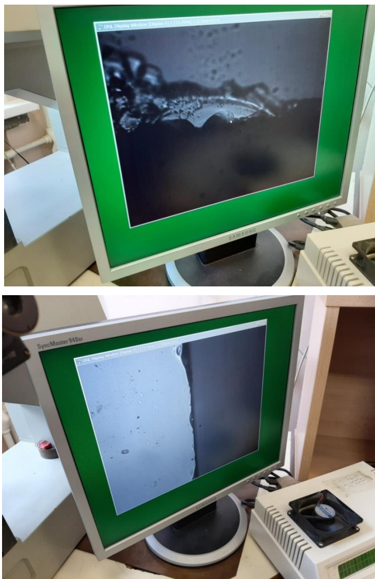
Рисунок 3.9 – Различное качество обработки граней стекол (изображение с микроскопа с объективом 40 \times )
