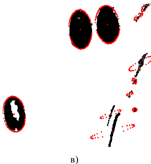
Рисунок 3.13 – Результат обработки следов ионов ^{132}\text{Xe}^{26+} с энергией 1 МэВ/А (под углом 60^\circ к нормали) после травления плавиковой кислотой в течение 9 часов: а) – исходное изображение на микроскопе; б) – результат обработки изображения с помощью разработанной программы; в) – небольшой фрагмент результата обработки. Большая ось эллипса 18 мкм, малая 11 мкм.
