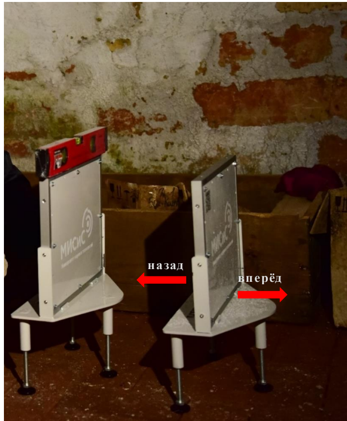
Рисунок 4.4 – Детекторы первой экспозиции, установленные в подвале ЦПБМ. Положение детекторов контролировалось по уровню.
