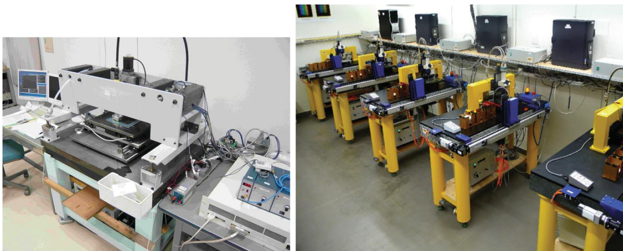
Рисунок 1.11 – Слева: Одна из сканирующих систем Nagoya S-UTS; справа: сканирующая станция в Берне, оснащенная пятью микроскопами ESS с автоматическими устройствами смены пленки
