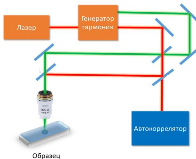
Рис. 2.5 Схема установки для лазерной записи: 1) Лазерная система Satsuma; 2) генератор гармоник (генерация второй гармоники 515 нм); 3) автокоррелятор – измерение длительности импульсов; 4) высокоотражающие зеркала; 5) образец – пластина из диэлектрического материала.
