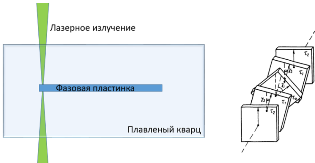
Рис. 4.7 Геометрия формирования фазовой пластинки в объёме плавленого кварца (вид с торца) и схематическая геометрия пятиэлементной составной симметричной полуволновой пластинки [142].
