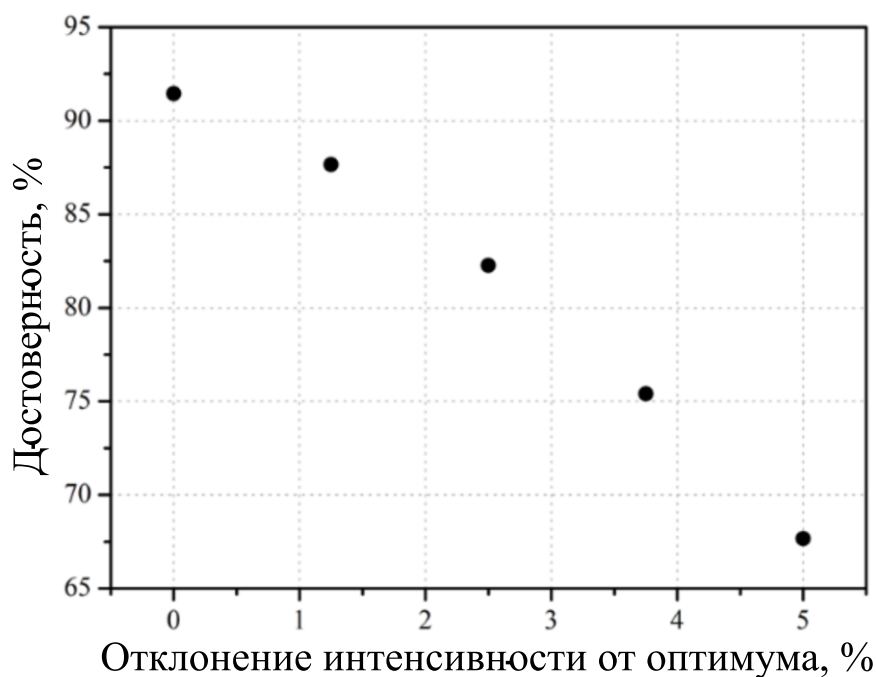
Рис. 8 Зависимость достоверности операции запутывания от отклонения интенсивности лазерных пучков от оптимального значения.
