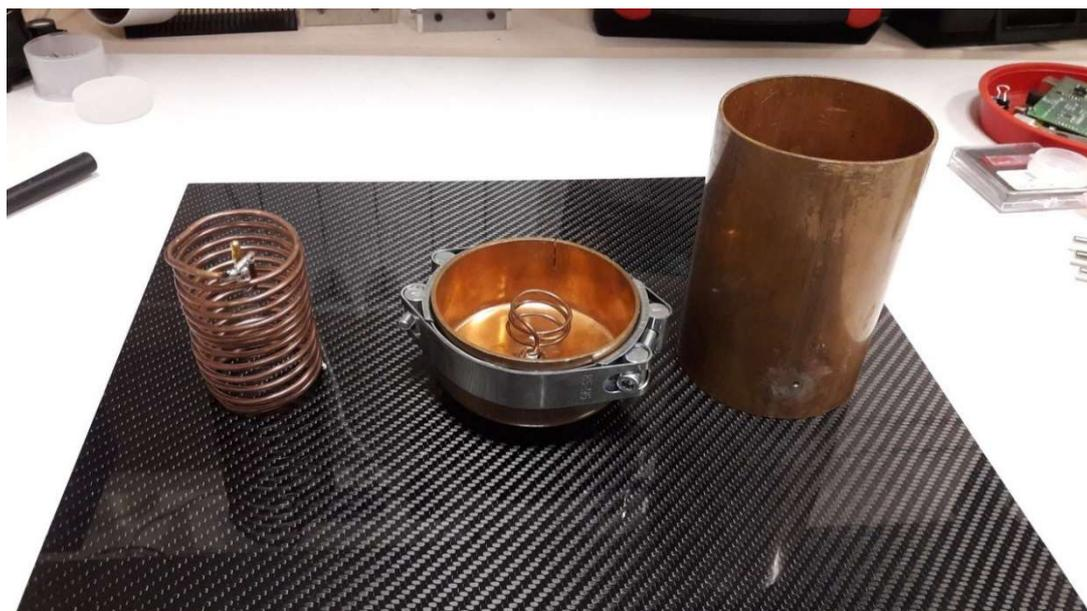
Рис. 2.12 Резонансный трансформатор в разобранном виде
