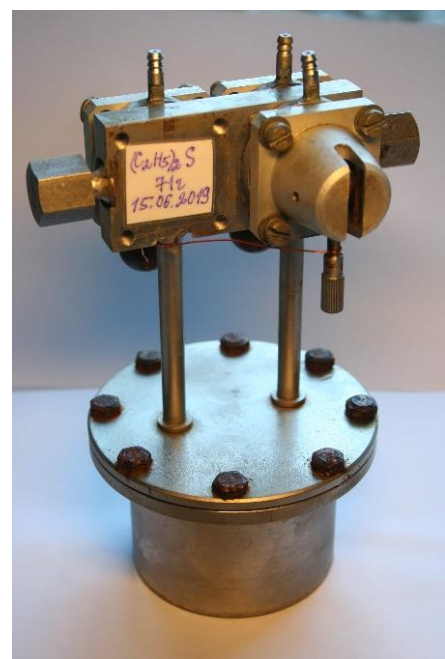
Рисунок 30 - а) Схематический вид барботера вместе с термокамерой: 1, 2, 3 – краны, 4 – линия «by pass», 5 – барботер, 6 – теплоизоляция, 7 – элемент Пельтье; б) внешний вид барботера.
