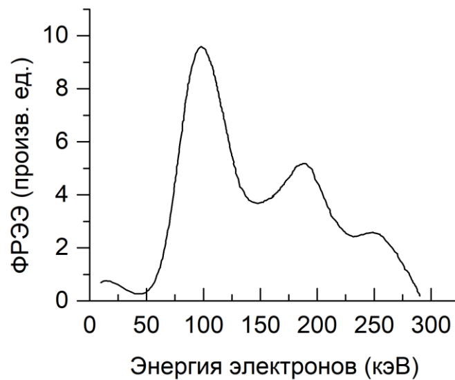
Рис. 2-2. Функция распределения электронов ускорителя РАДАН-ЭКСПЕРТ по энергиям [121].
