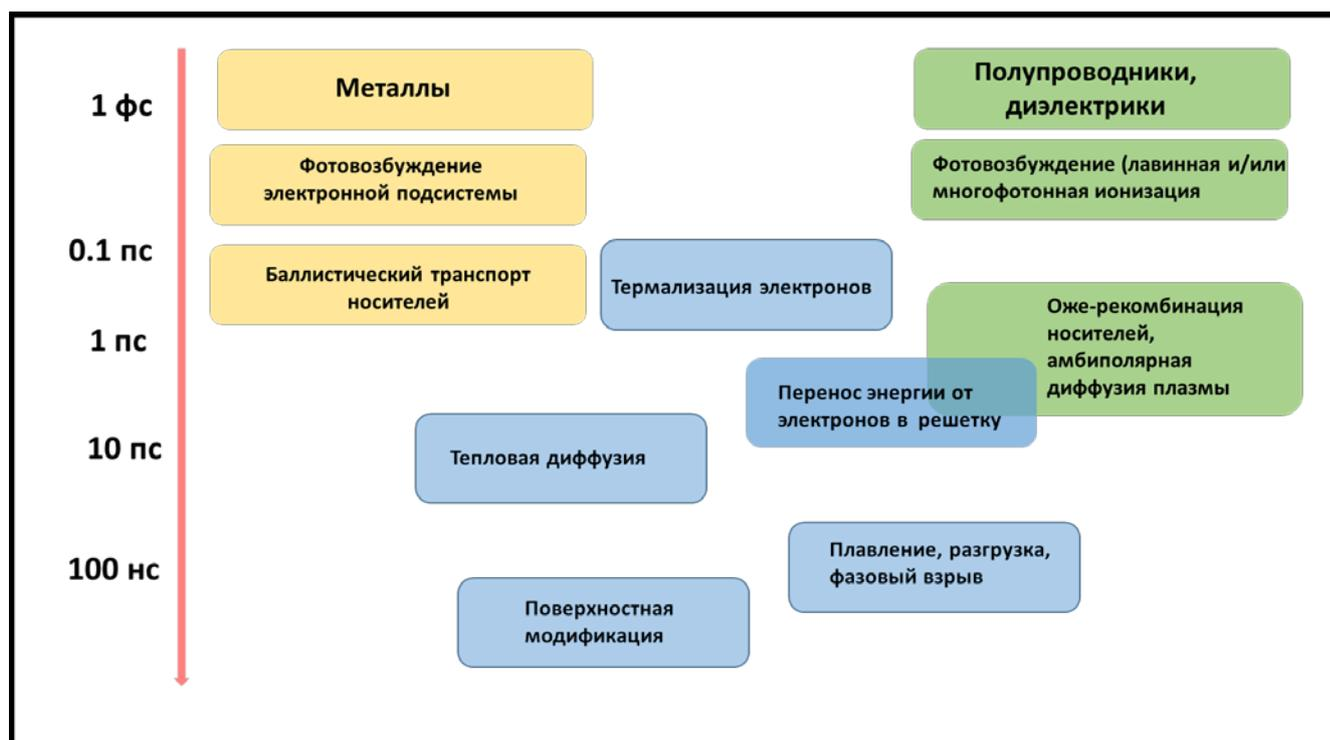
Рис.1.1. Схема поглощения энергии и фазовые превращения после возбуждения материала ультракороткими лазерными импульсами для разного рода материалов.
