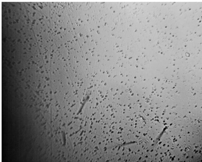
Рис. 11. Фотография поверхности кристалла ML-11-10 из палласита Марьялахти с высоким градиентом плотности треков ядер железа. Размер изображения составляет  $284 \times 226$  мкм.
