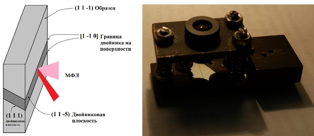
Рис. 21. Кристаллографическая структура образца (слева). Изображение криогенной вставки с микрообъективом и образцом (справа).
