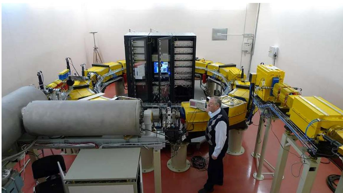
*Рис. 1. Внешний вид протонного синхротрона комплекса протонной терапии «Прометеус» ФТЦ ФИАН (Протвино). Характеристики: Энергия пучка - 30-250(330) Мэв  $\pm 0.15\%$ ; Интенсивность пучка  $-10^9 \text{ с}^{-1}$ ; Время ускорения до макс. энергии – 1 сек.; Медленный выпуск пучка в диапазоне – 0.1-10 сек.; Средняя потребляемая мощность 50 кВт*
