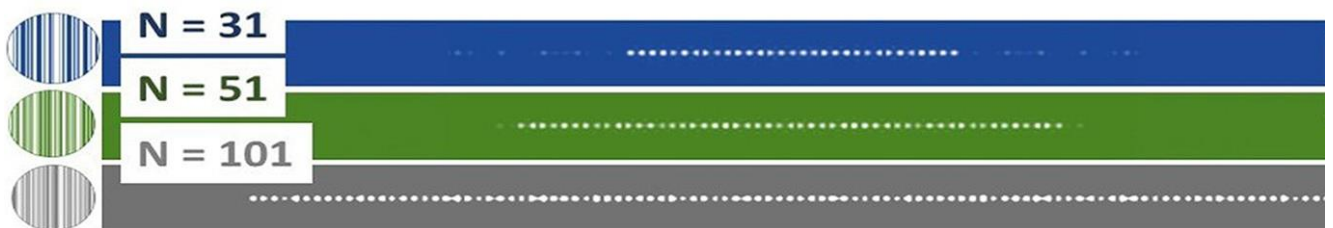
Рисунок 4.9. Фазовая картина изготовленных ДОЭ с распределением интенсивности в виде линейного массива из 31, 51 и 101 точки и соответствующие им рассчитанные распределения интенсивности в фокальной плоскости.
