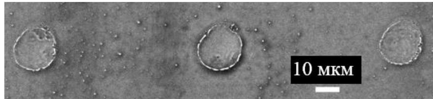
Рис. 2.2. СЭМ изображение микрократеров, полученных на массивной Si мишени в среде изопропанола в режиме одноимпульсного воздействия при  $\tau \approx 4.1 \text{ пс}$ ,  $E \approx 6 \text{ мкДж}$ .
