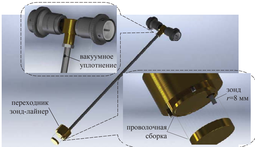
Рис. 21. Магнитный зонд с устройством для крепления проволочной сборки.
