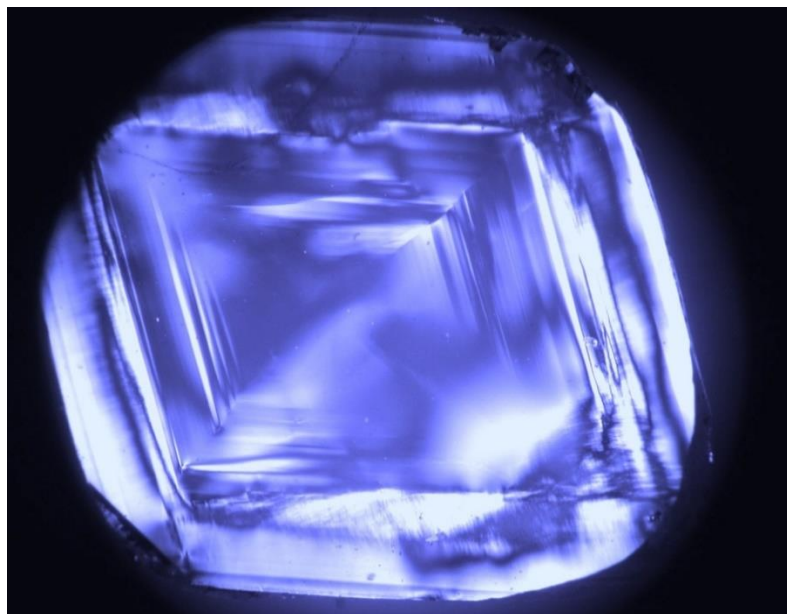
Рис.3.9. Оптическое изображение кристаллической пластинки алмаза (1 1 0), полученное при помощи оптического микроскопа в поляризованных лучах
