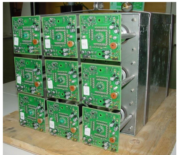
Рис. 4.7 Модуль семплингового калориметра.
