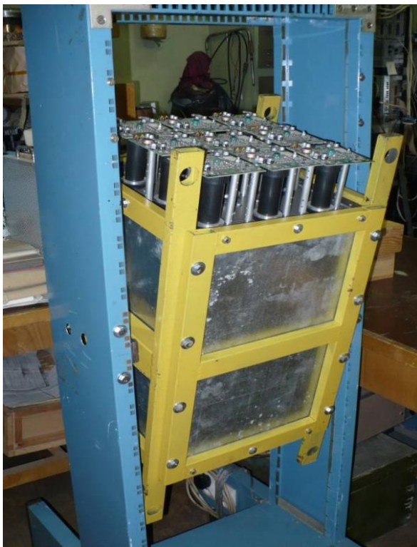
Рис. 4.8 Семплинговый калориметр из 9 модулей в монтажной стойке.
