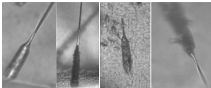
Рис. 6. Микрофотографии травимых треков тяжёлых ионов в оливине. Размер одного поля зрения (60-100) \times 140 микрон [28].
