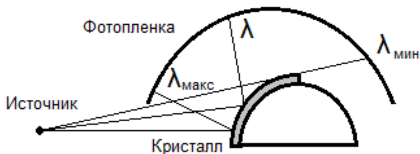
Рис.5.5. Схема кристаллического спектрографа с выпуклым кристаллом.
