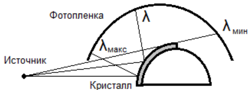
Рис.17. Схема кристаллического спектрографа с выпуклым кристаллом.
