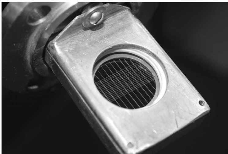
Рис. 1.5. Сеточный вторично эмиссионный датчик, сконструированный для ВЭП-2000. Диаметр отверстия 17,5. Позолоченные проволочки натянуты с шагом 0,5 мм в вертикальной плоскости и с шагом 1,5 мм в горизонтальной плоскости. Диаметр проволочек 28 мкм [42].
