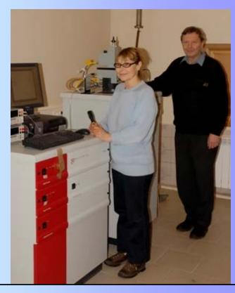
Многофункциональная установка PPMS-9 (теплоемкость, магнитный момент, проводимость - в диапазоне температур 0,3 – 400К и полей до 9Тесла)
