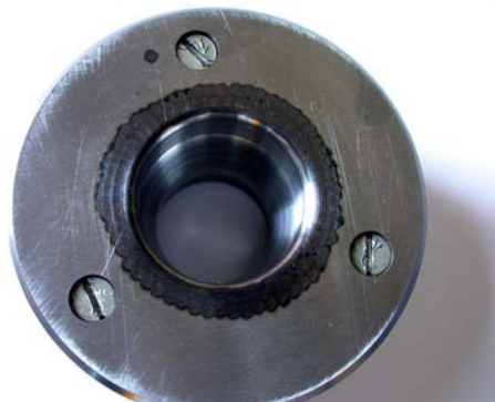
Комплект вытяжного штампа, матрица – ШХ15, пуансон – Х12М
