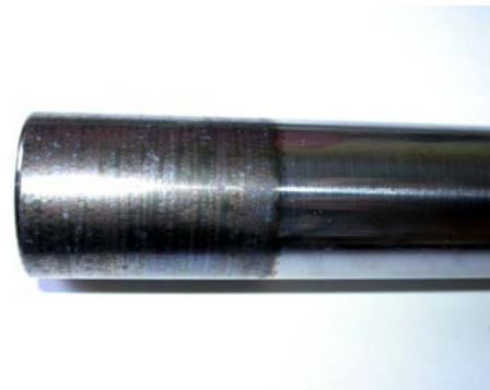
Комплект вытяжного штампа, матрица – ШХ15, пуансон – Х12М
