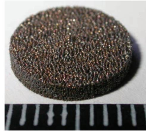
Рис. 2. Внешний вид синтезированного методом СЛП образца. Диск 10 мм диаметром.
