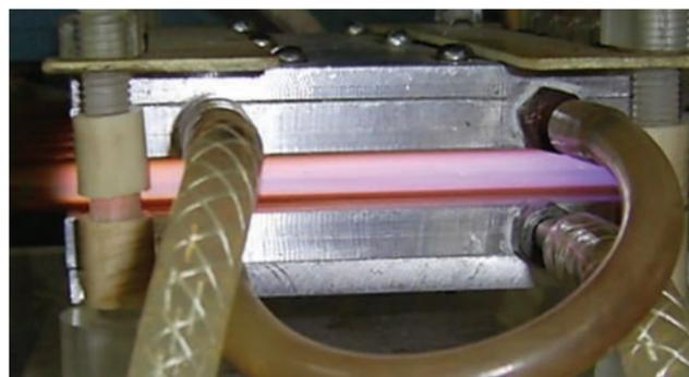
Рис. 1. ВЧ разряд в кварцевых трубках между плоскими электродами. Изменение цвета вдоль потока справа налево обусловлено изменением химического состава смеси.
