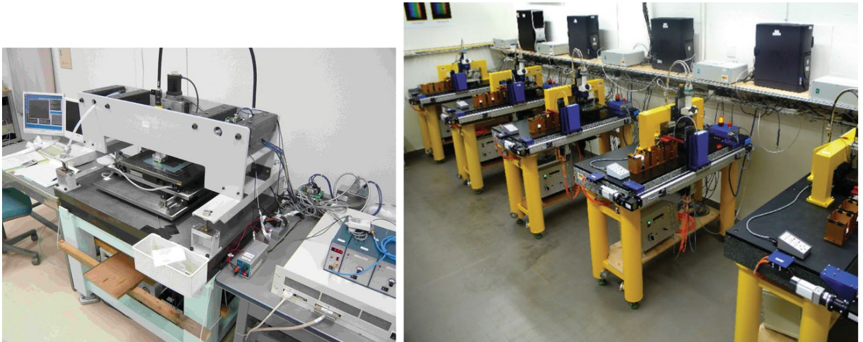
Рисунок 1.11 – Слева: Одна из сканирующих систем Nagoya S-UTS; справа: сканирующая станция в Берне, оснащенная пятью микроскопами ESS с автоматическими устройствами смены пленки
