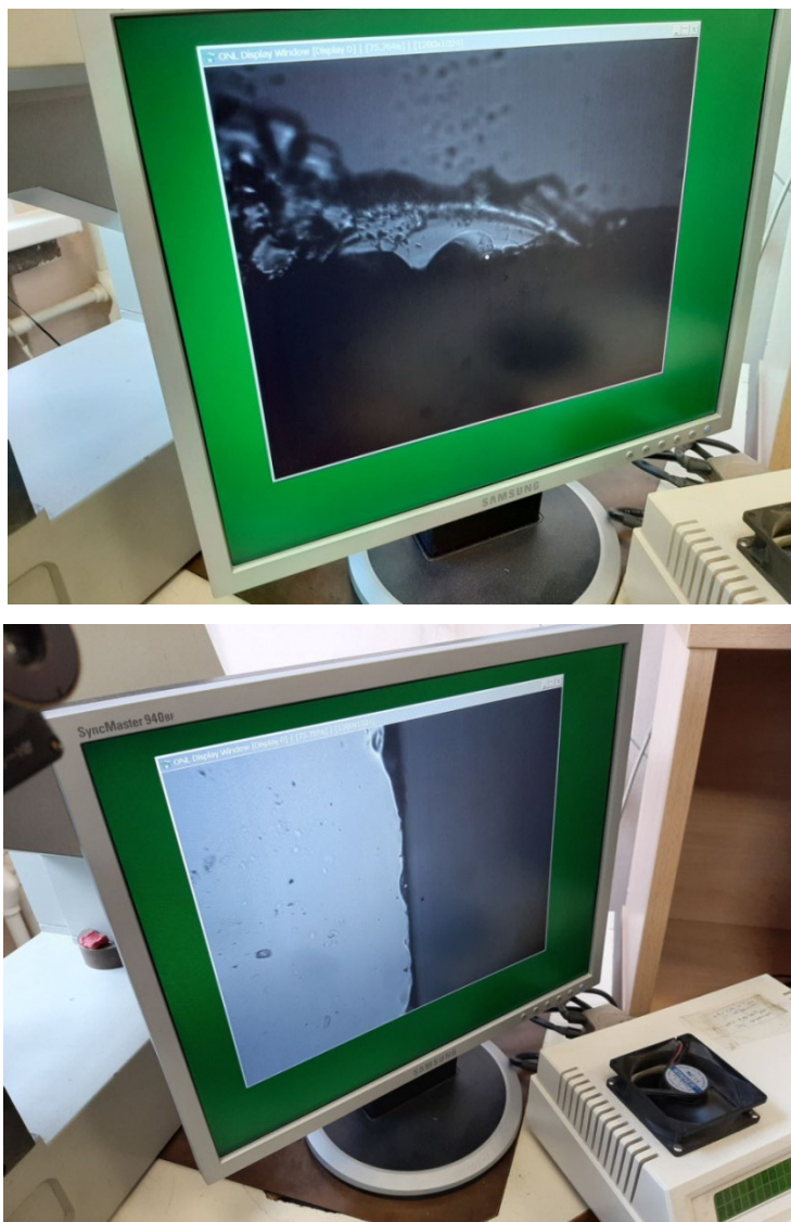
Рисунок 3.9 – Различное качество обработки граней стекл (изображение с микроскопа с объективом 40 \times )
