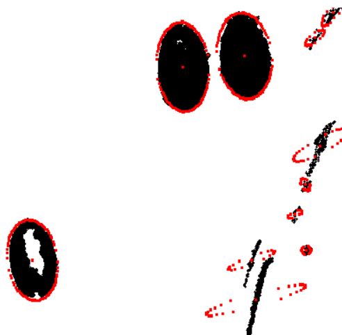
Рисунок 3.13 – Результат обработки следов ионов ^{132}\text{Xe}^{26+} с энергией 1 МэВ/А (под углом 60^\circ к нормали) после травления плавиковой кислотой в течение 9 часов: а) – исходное изображение на микроскопе; б) – результат обработки изображения с помощью разработанной программы; в) – небольшой фрагмент результата обработки. Большая ось эллипса 18 мкм, малая 11 мкм.
