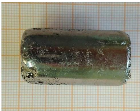
Рис. 2.1. Внешний вид слитка  $(\text{Cd}_{1-x}\text{Mn}_x)_3\text{As}_2$  [128].
