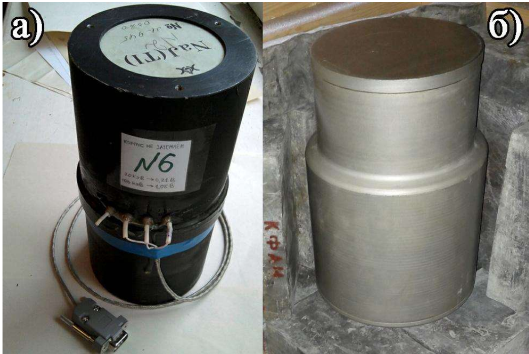
Рис.1.10. Внешний вид малого (а) и большого (б) спектрометров без сопоставления масштабов.
