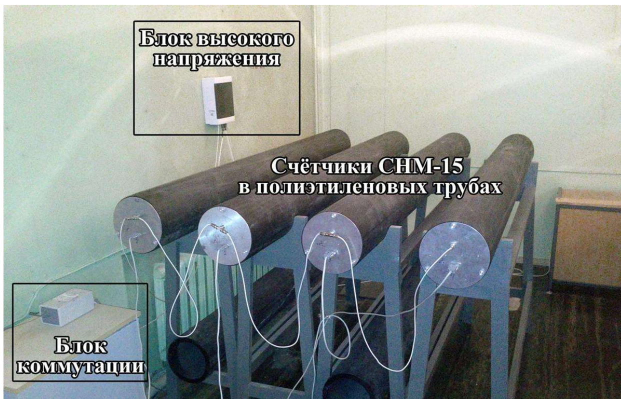
Рис.1.4. Внешний вид бессвинцовой секции нейтронного монитора.
